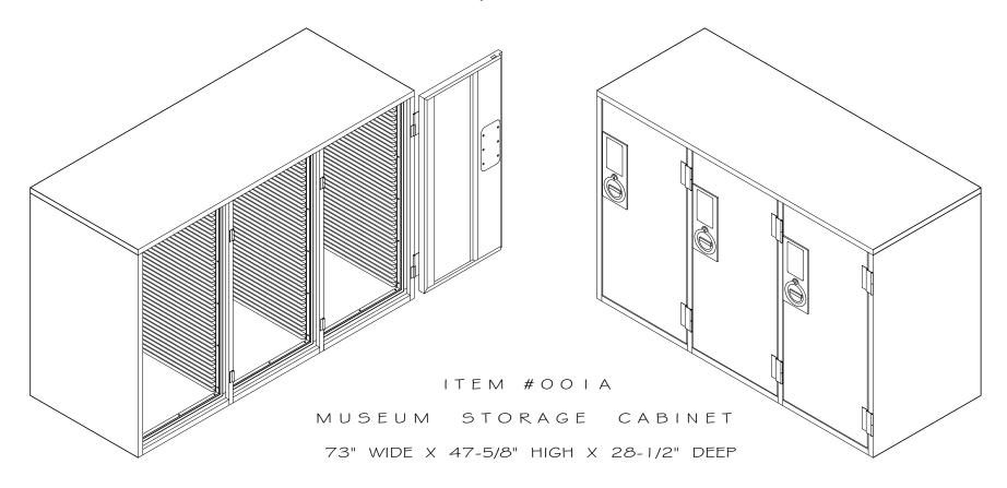
THREE STEEL DOORS - LIFT-OFF HINGES
